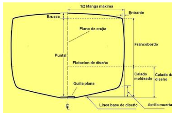
Fig. 2: Diagrama de las dimensiones de un buque
